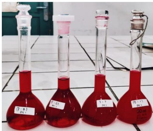
**Gambar 1.** Hasil ekstraksi kulit ubi jalar ungu menggunakan 4 variasi perbandingan pelarut etanol 96%:HCl 1% dengan perbandingan a) (9:1); b) (7:3); c) (5:5); d) (3:7)
