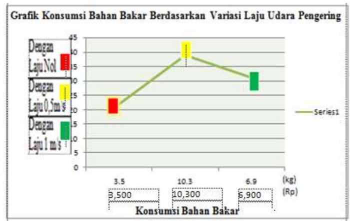
Gambar 5.8 Uji Konsumsi Bahan Bakar berdasarkan laju udara pengering
